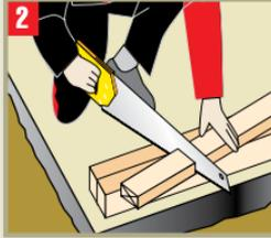
**2** Cortar los pie derechos de acuerdo a la altura del muro. Descontar el espesor de la madera de las soleras.
