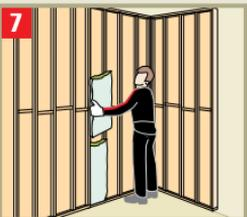
**7** Instalar el material aislante seleccionado, cuidando que no queden espacios, y que quede apoyado hacia la cara interior del muro.
