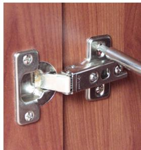
• **Hacia adentro o afuera del mueble:** Soltar el perno que se indica en la figura, rectificar la posición y apretar.
