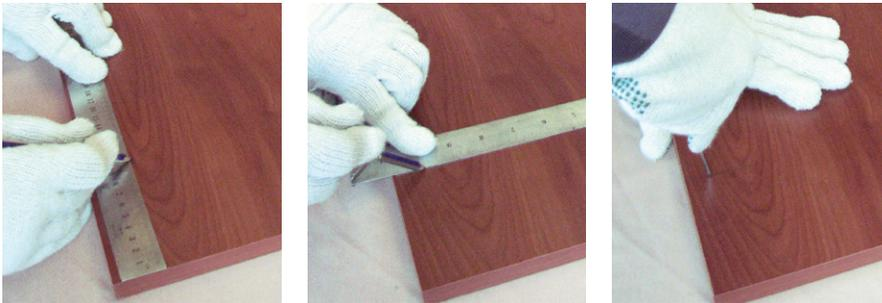
Luego perforar usando la fresa, cuidando de no traspasar hacia el frente de la puerta.
