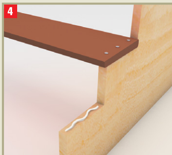
Instalación de peldaños:
