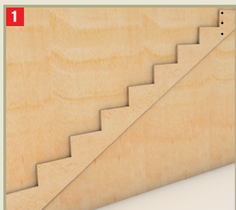
Fijar limones a la estructura.
