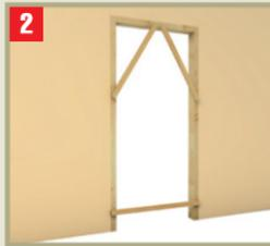
**2** Fijar las piezas del marco, usando tirantes de madera que mantengan el marco en posición. Sacar la puerta y presentar el marco en el vano.
