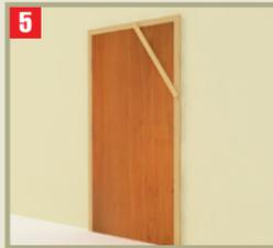
**5** Instalar el tope, en el caso de un marco tipo centro. Para ello, fijar una pieza por el lado exterior, para que la puerta quede en la posición que estará cerrada. Clavar y pegar con cola fría el tope por el lado interior.
