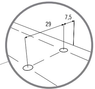
Estas perforaciones de 10mm de diámetro, deben atravesar el tablero para facilitar la introducción holgada de los tarugos y evitar el movimiento de la baranda removible.
