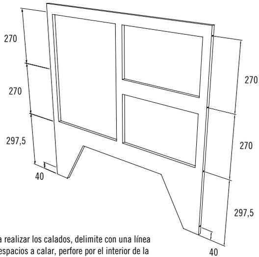
Para realizar los calados, delimite con una línea los espacios a calar, perforo por el interior de la línea con una broca de 10mm y proceda a cortar con la sierra eléctrica.
