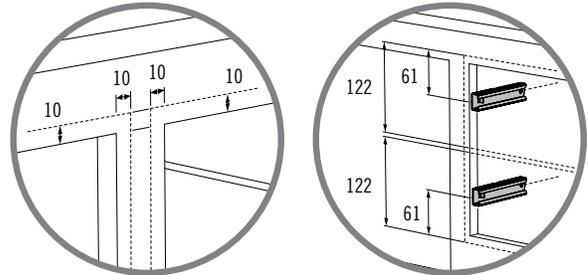
Utilice el mismo procedimiento señalado para la instalación del cajón con la Pieza M.
