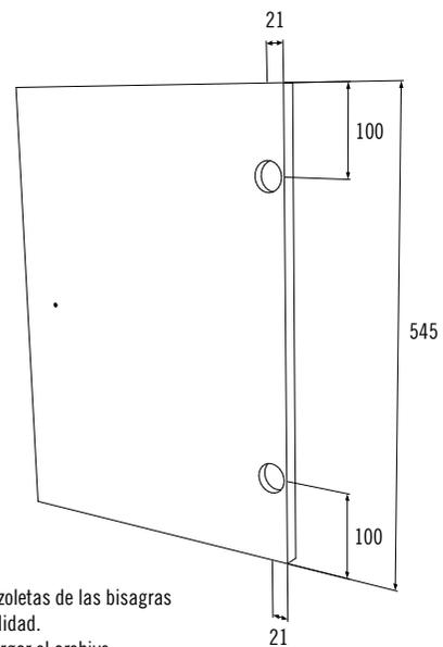
Las perforaciones para las cazoletas de las bisagras deben tener 12mm de profundidad.
