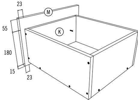
Para la fijación de las tapas por el interior de los Cajones, trace una línea desde el borde superior a 40mm en las Piezas H, 80mm en las Piezas K y 30mm desde ambos costados como mínimo, perforo y fije.
