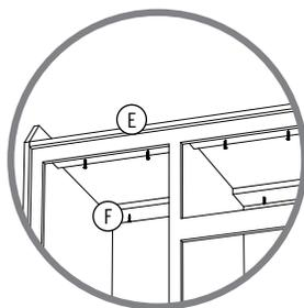
Fijación desde la parte interior con tornillos autorroscantes.
