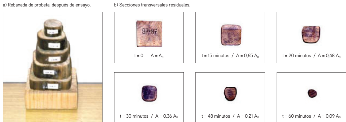
Figura 4: Efecto de redondeo de aristas durante la combustión.
