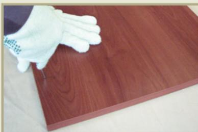
Luego perforar usando la fresa, cuidando de no traspasar hacia el frente de la puerta.
