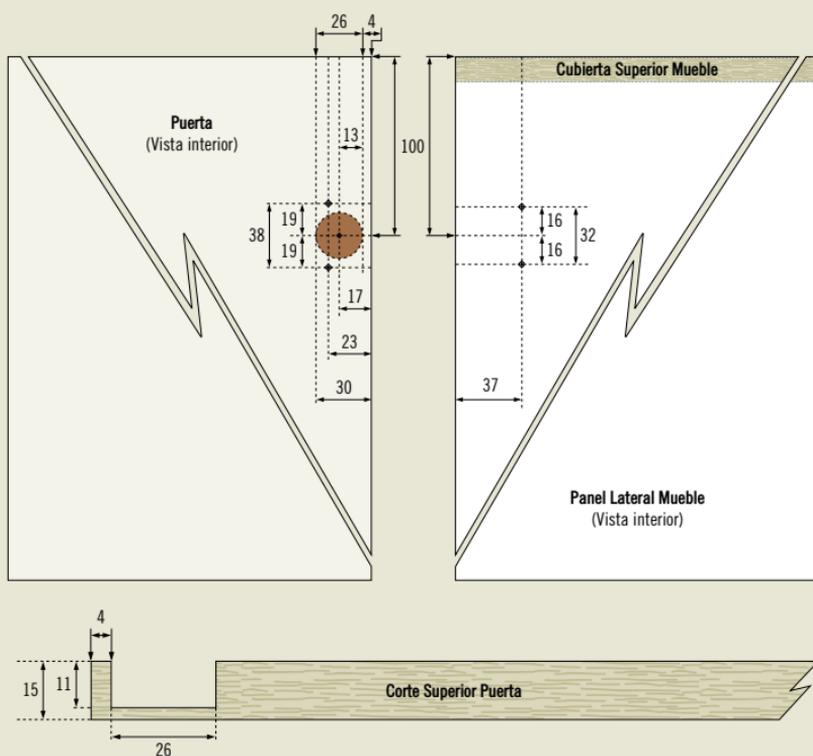
● = Indica diámetro perforación para Cazoleta de la Bisagra.
