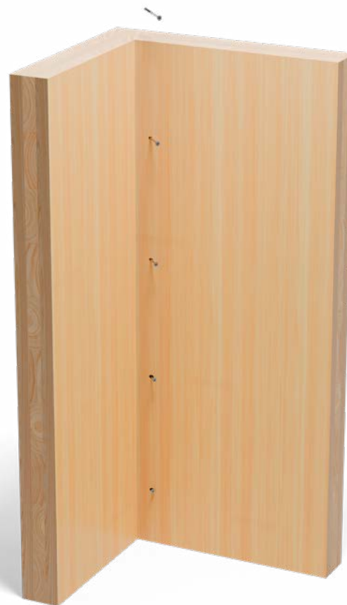
Unión de esquina con tornillos
