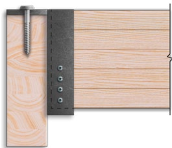
Fijación con clavos: Correcto.
