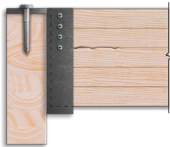
Fijación con clavos: Resultado de un detalle incorrecto.
