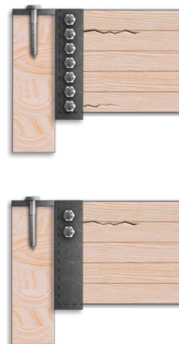
Fijación con tornillos: Resultado de un detalle incorrecto.
